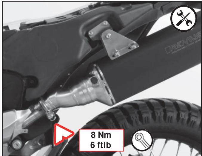
**Alle ausgebaute Standardteile wieder montieren.**
