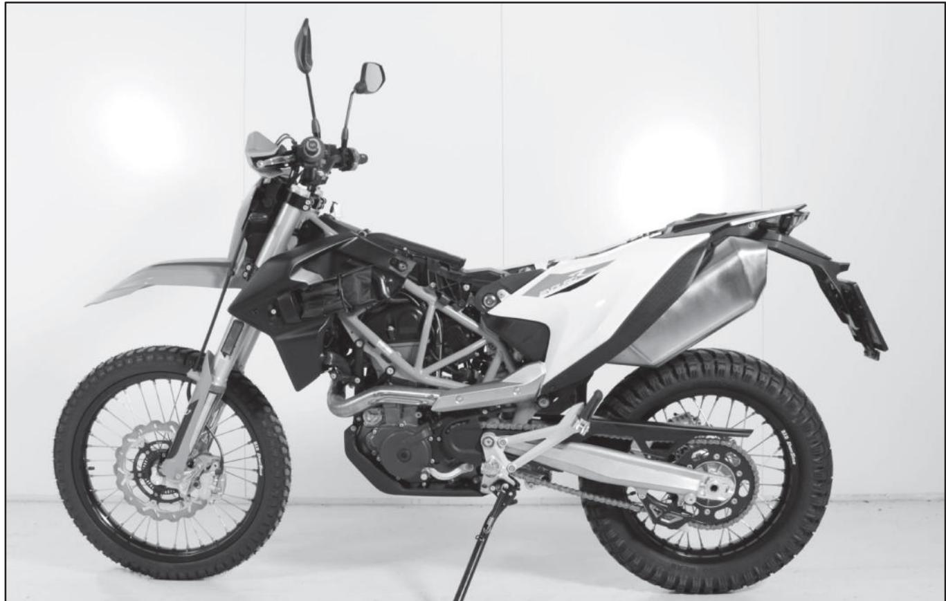
**Desserrez la vis d'équerre de fixation et le collier de serrage du silencieux de série et retirez le silencieux.**
