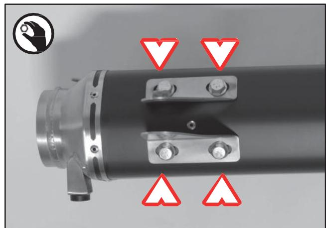
Den vorhandenen Haltebügel entfernen und an den REMUS-Sportauspuff montieren.
