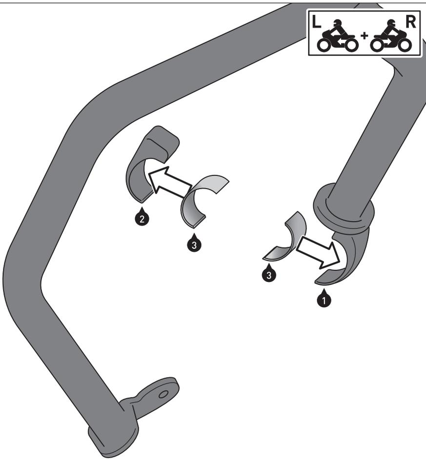
Reinigen Sie die Oberflächen der Schellen der Sturzbügel (1) und der Schellen (2) gründlich von Fett- und Schmutzrückständen.
