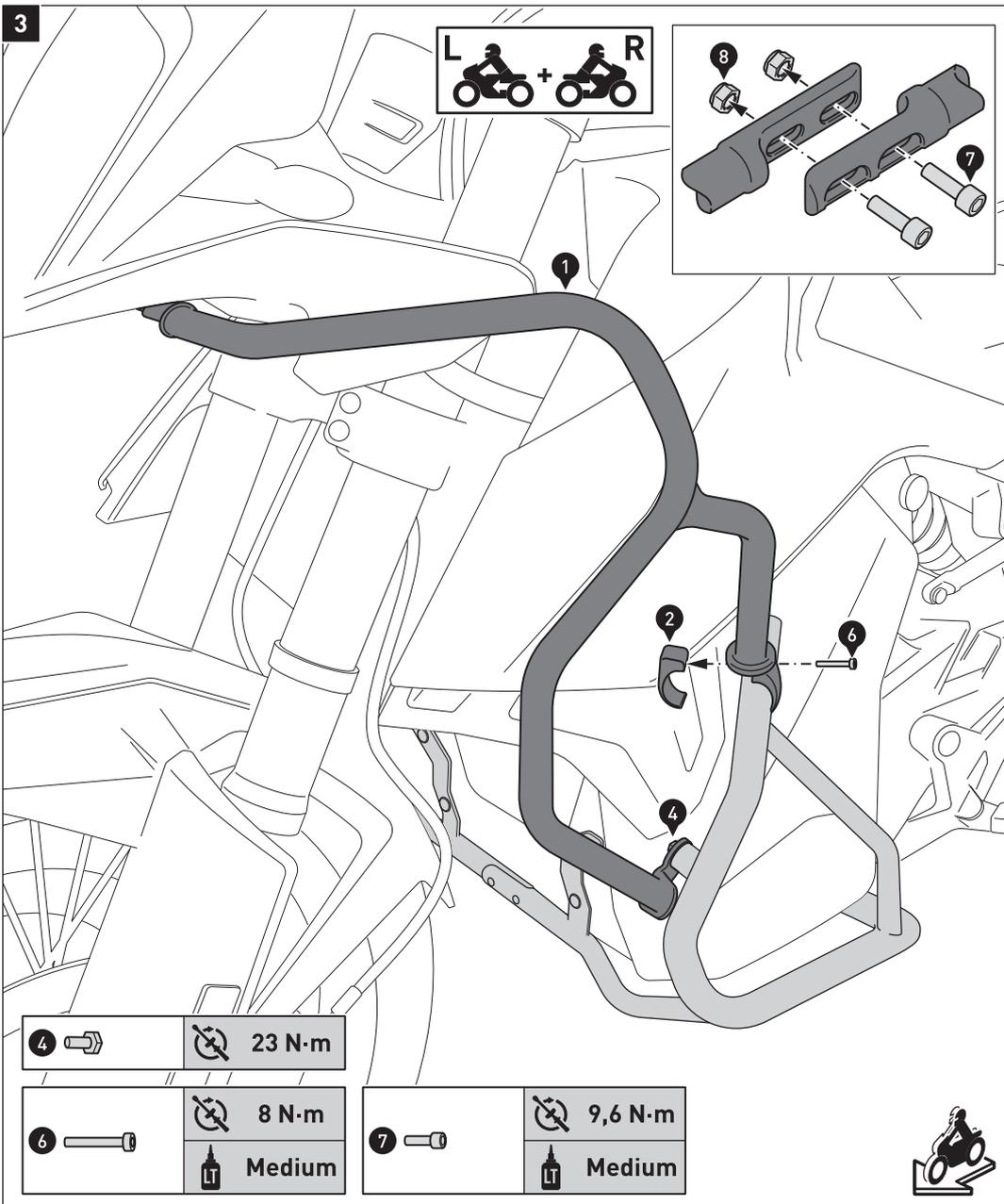
Verschrauben Sie die oberen Sturzbügel (1) beidseitig mit den Schellen (2) am Sturzbügel, wie in der Zeichnung gezeigt.
