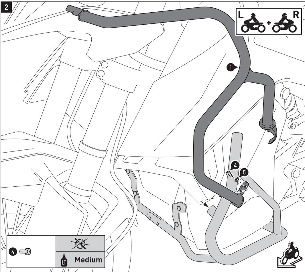
Verschrauben Sie die oberen Sturzbügel (1) beidseitig auf den Sturzbügeln, wie in der Zeichnung gezeigt.
