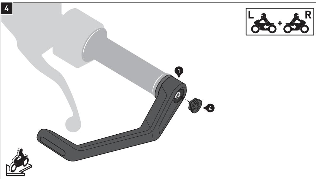
Setzen Sie **beidseitig** die Abdeckkappen (4) in die Öffnungen der montierten Hebelschützer (1) ein.
