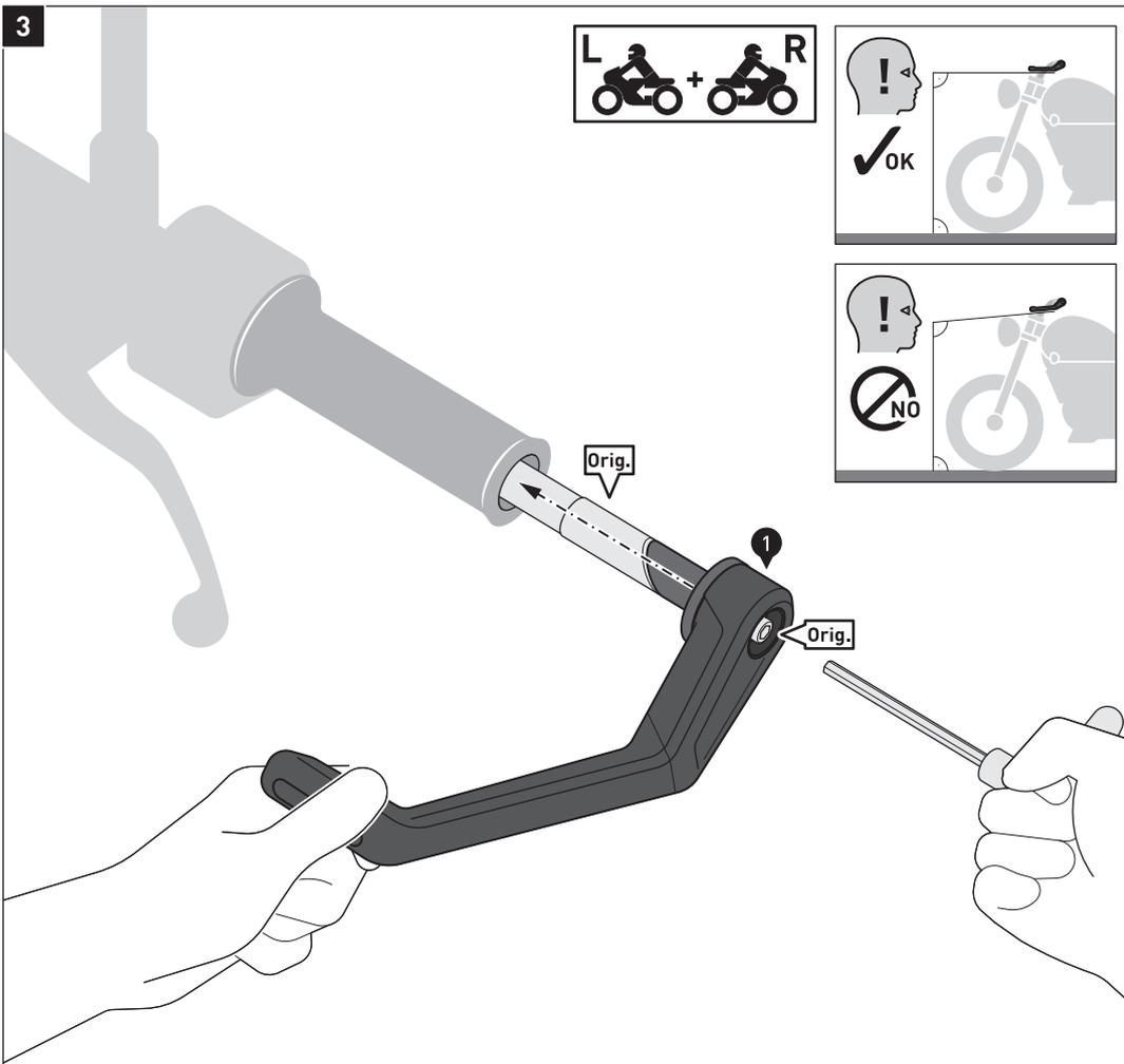
Stecken Sie die Klemmbuchsen **beidseitig** bis zum Bund in die offenen Lenkerenden.
