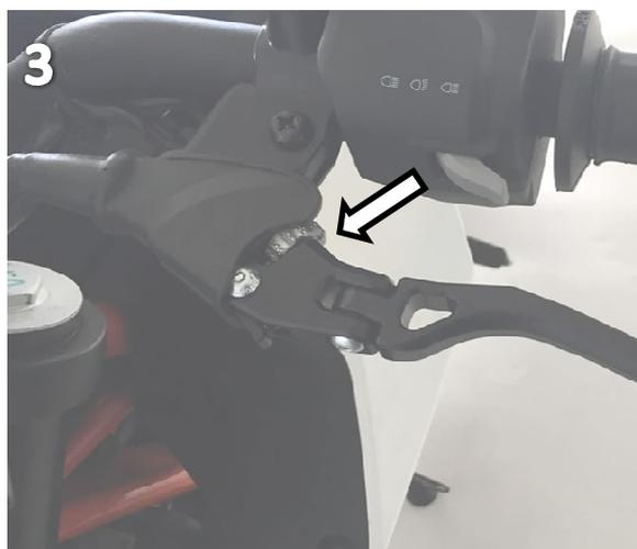
Der Hebel ist durch Drehen des Verstellhebels im Abstand einstellbar.
