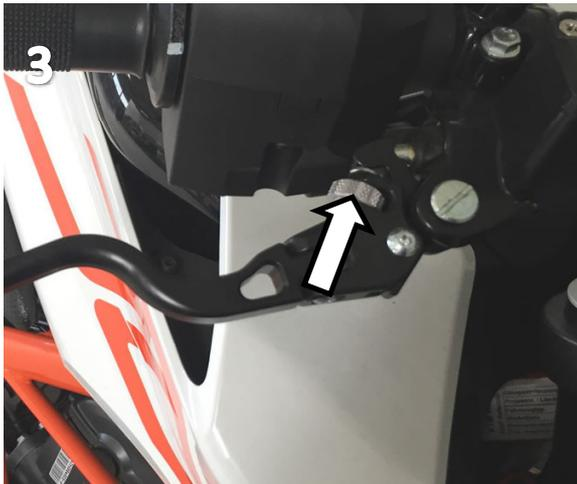
Der Hebel ist durch Drehen des Verstellrads im Abstand einstellbar.
