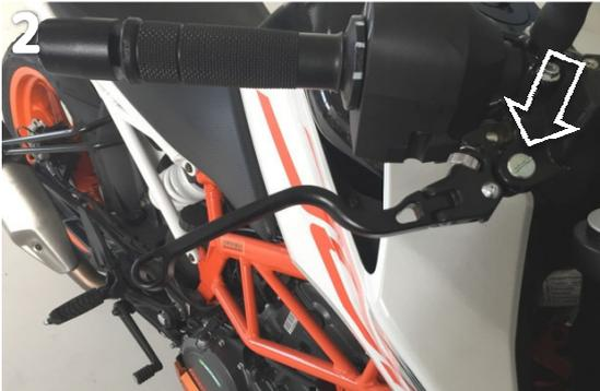
Bauen Sie den Hebel mit der Originalschraube und -mutter wieder an. Ziehen Sie die Mutter mit einem Drehmoment von 8 Nm fest (Bild2).
