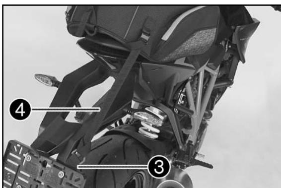
Les sangles de fixation ④ peuvent éventuellement être placées sur la plaque. À cet effet, monter les fixations ③ (étendue de la livraison) avec la vis de plaque à gauche et à droite avant d'enfiler les sangles de fixation ④ par les anneaux.
