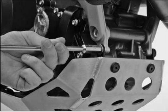
Sechskantschrauben M6x16 des vorderen Haltebügels mit 15 Nm festziehen.
