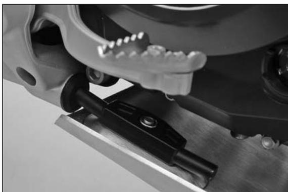
Guider les fixations de la protection moteur en alu dans les bagues en caoutchouc.
