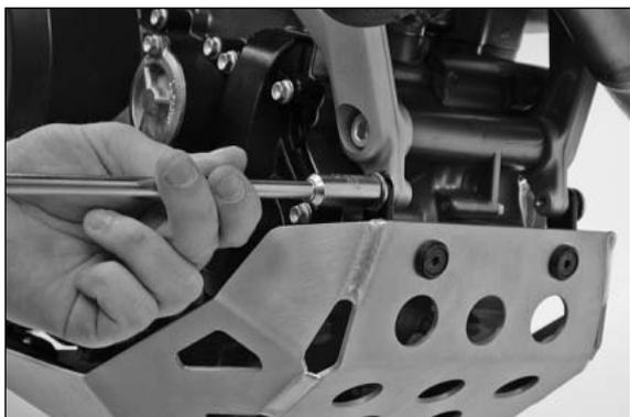
Apretar los tornillos de cabeza hexagonal M6x16 del estribo de sujeción delantero con un par de 15 Nm.
