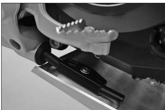
Halterungen des Alu Motorschutzes in die Gummibuchsen einführen.
