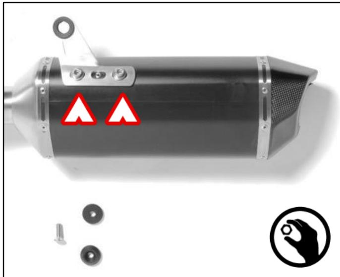
Montare le due rondelle di spallamento sul supporto precedentemente montato.
