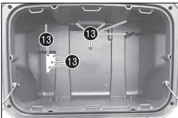
**Smontaggio della serratura**
