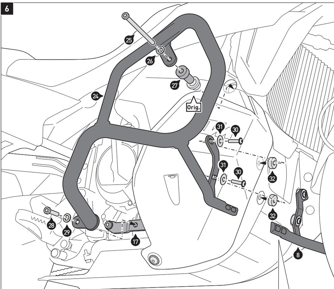
Verschrauben Sie den Sturzbügel (24) am Fahrzeug und dem Anbaublech (17), wie in der Zeichnung gezeigt. Verwenden Sie den original Gummidämpfer (Orig.) an dem oberen Anbaupunkt.
